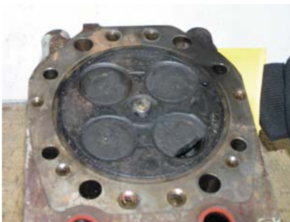
Rys. 1. Głowica cylindra z uszkodzonym zaworem wylotowym
